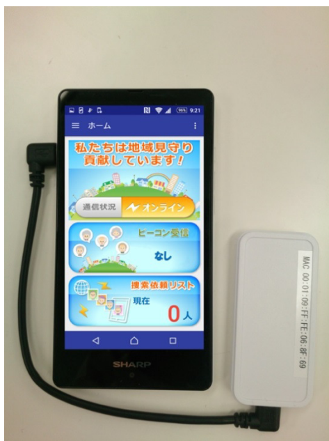
写真 2 モバイル Wi-SUN ルータの外観
